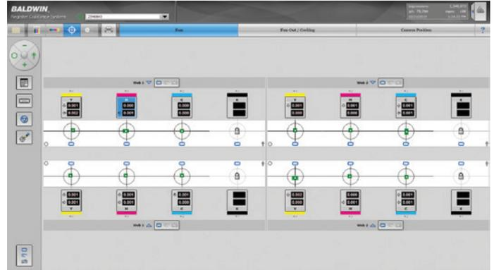
配備 MultiCam 的套准可以同時顯示所有的印刷單元，並能自動控制並確保印刷誤差在設定的範圍以內。
