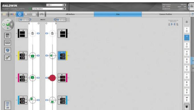
系統的運行顯示幕為操作員提供與已建立標記相關的套准性能視圖，並提供任何偏差的即時通知。
